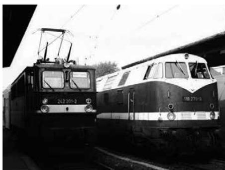
Foto: E-Lokomotive 242 & Diesellokomotive V 180
